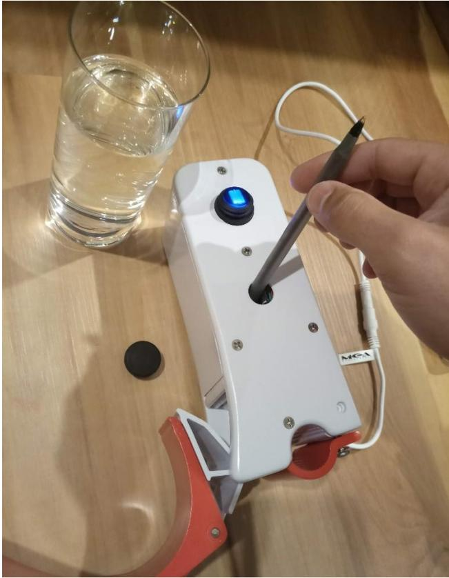
**Appuyer 5X** sur l'autre interrupteur rectangle blanc à l'intérieur du boîtier principal.
